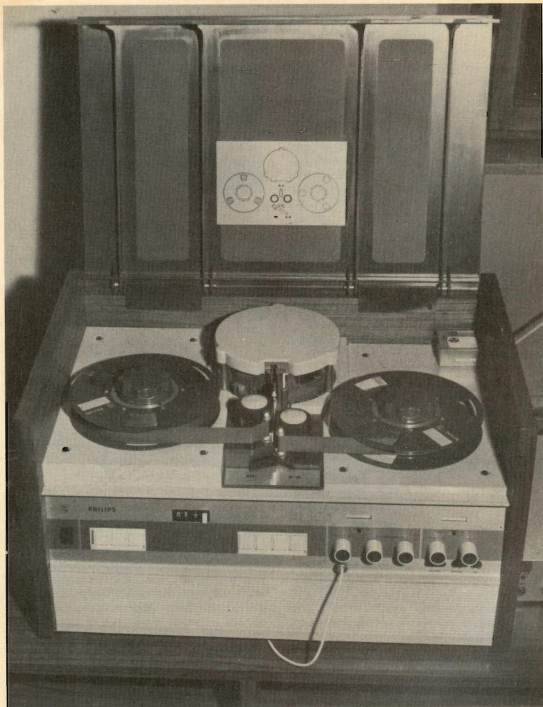
Al centro tra le due bobine si trova il tamburo fisso dentro al quale una testina ruotante (50 giri al secondo) incide il nastro che scorre a elica sulla superficie esterna del tamburo alla velocità di 19 cm/s.
