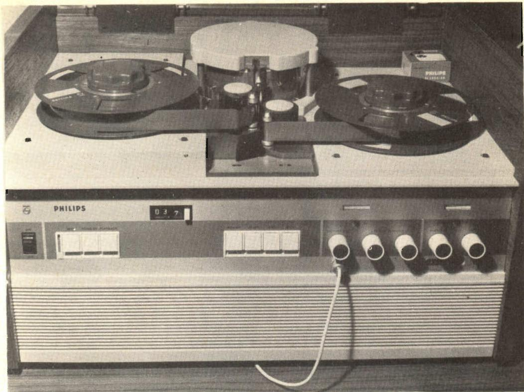
Il Video Recorder visto dalla parte anteriore. Si vedono molto chiaramente le funzioni dei comandi che sono ridotti al minimo. Si noti in particolare la posizione d'entrata del nastro e quella d'uscita. Ciò è dovuto al fatto che il nastro lungo la superficie esterna del tamburo si muove « a vite ».
